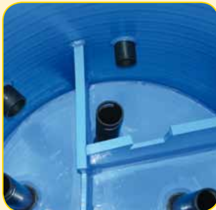
Zulauf- und Sammelbecken mit getrennten Einlaufkammern während der Herstellung
