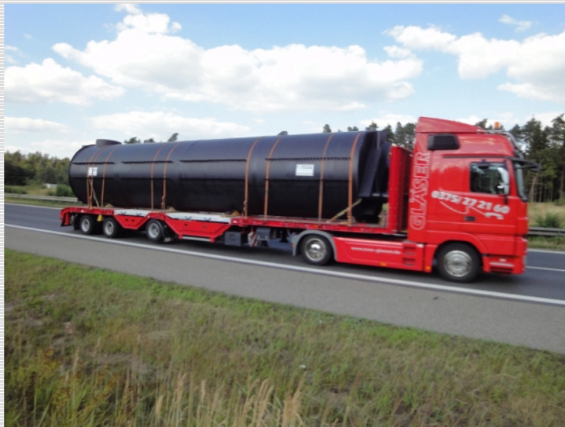
Abb. 3: Transport des Verteilerschachtes zur Baustelle
