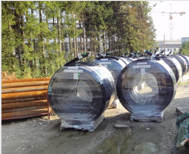
Abb. 2: Duplex-Erdwärmesonden PE 100-RC d 40mm
